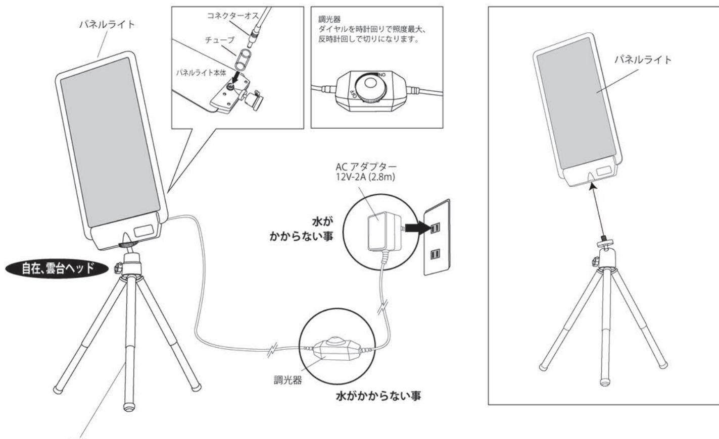
● 右図の様に、三脚をパネルライトをねじ込み、各コネクターを接続してからアダプターをコンセントに差し込みます。
