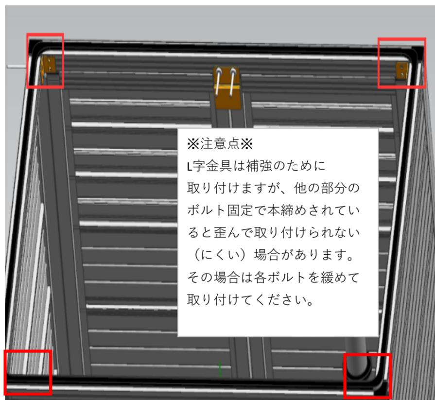
4. 本体をゆっくり倒していただき、底面に底板補強バーをCボルト(M4x10)で取り付けてください。
