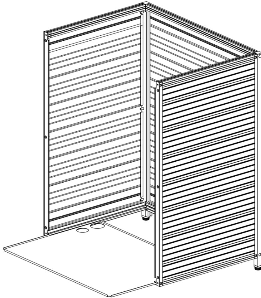
3. 前面パネルをAボルト(M5x30)仮締めしてください。
