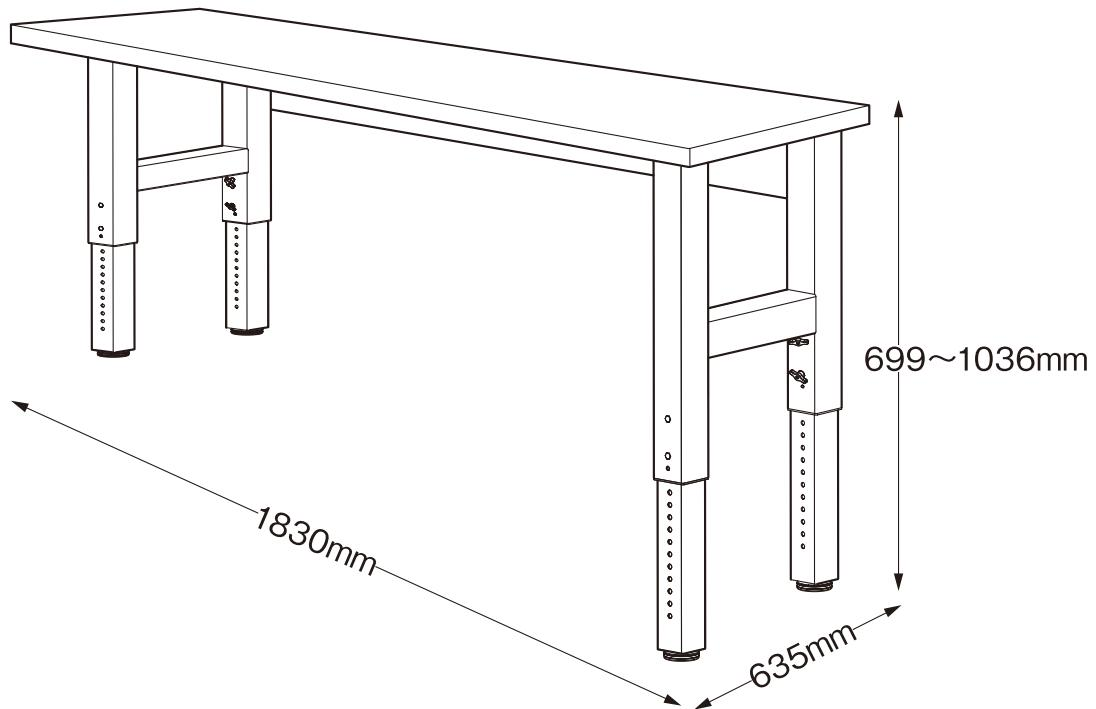
外形寸法：幅 1830mm×奥行き 635mm×高さ 最小699mm（最大1036mm） 14段階調整
