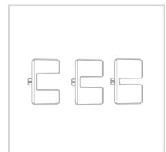
ドアのサムターンが合うサムターンアダプターを確認してロック本体に取り付けます。パッチと音がするまで押し込んでください。
