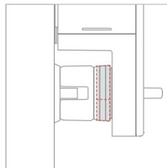
手でSwitchBotロックを固定しながら、SwitchBotロックのサムターンを回してスムーズに施錠・解錠できるかをテストしてください。
