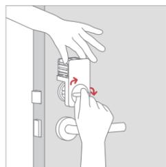
土台アダプターの高さを調節できたら、ネジをしっかりと絞めてください。電池カバーを閉めます。
