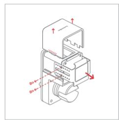
ドアロックに応じて土台アダプターの高さを調整します。高さを確認する前に、両面テープのはくり紙をはがさないでください。
