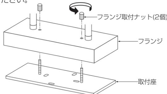
②取付面が充分乾燥してから器具を取付けてください。取付面の乾燥が不十分だと器具のメッキ部や塗装部が侵されたり、絶縁不良の原因となります。
