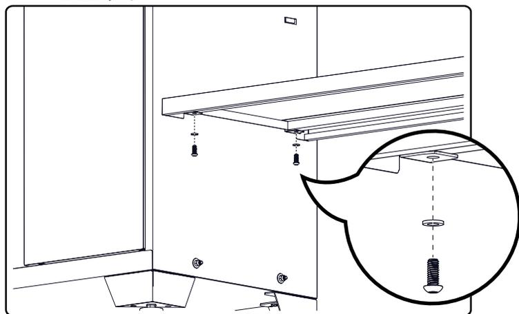
**4** 棚の反対側をワークベンチの脚にネジ2本とワッシャー2個で固定します。
