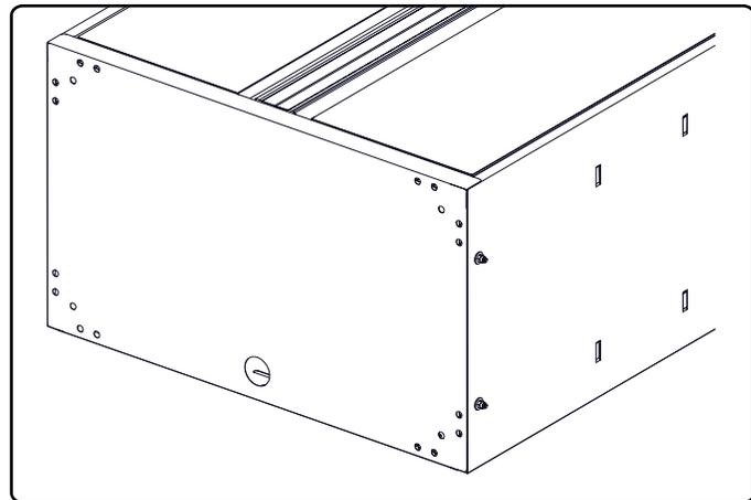
**3** 脚をキャビネットの端に合わせます。3番のプラスドライバーを使って、脚取り付けネジ4本をねじ込みます。
