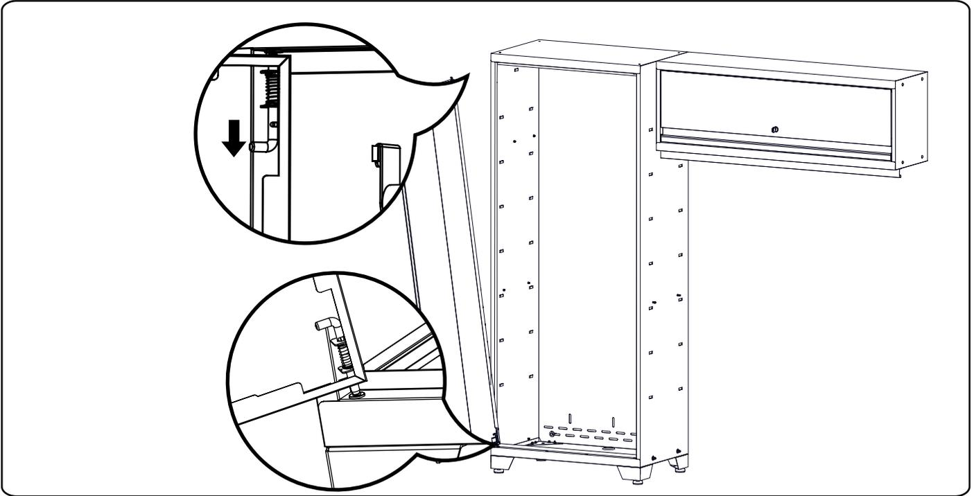
2 2本の1/4"六角ボルトと1/4"ワッシャーを締め、ワークベンチをロッカーに取り付けます。
