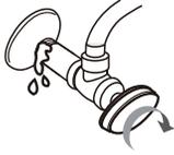
**止水栓、給水配管は固く締め付けてください。**
